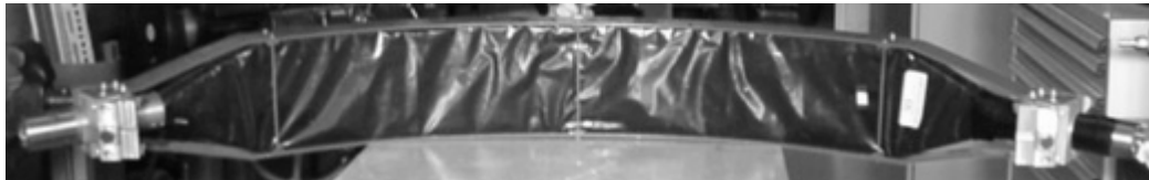
FigIII-7 : Photographie d'une latte de TONNERRE montée, on peut voir la structure métallique, ainsi que les PM et le guidage optique par la queue de poisson.
