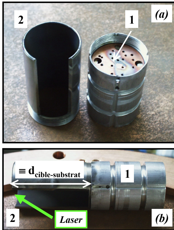
Fig. 6 : Porte-substrat formé de deux parties cylindriques. (a) Plaque (1) permettant de fixer les substrats tel que leur surface soit parallèle à celle de la cible. (b) La distance cible-substrat est déterminé par le cylindre n°2. Une encoche permet le passage du faisceau laser.
