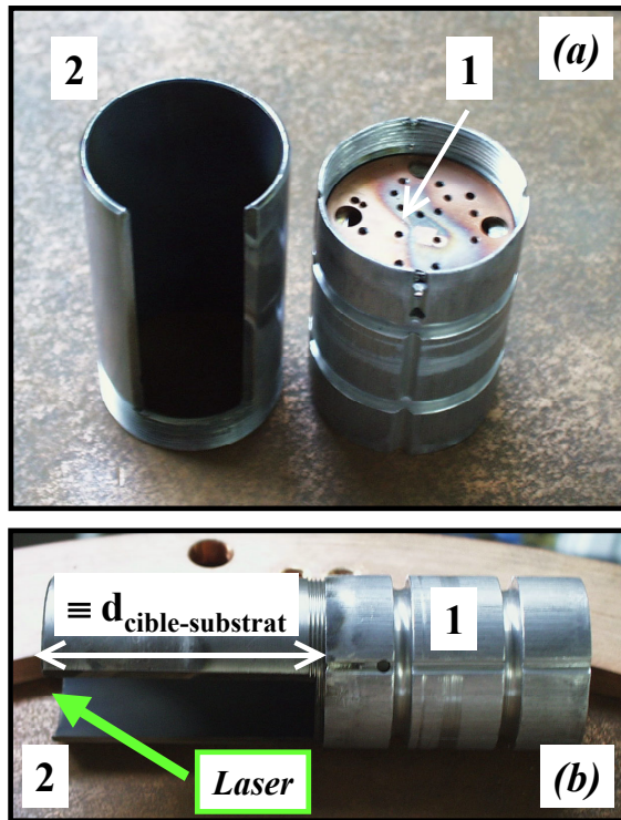
Fig. 6 : Porteur-substrat formé de deux parties cylindriques. (a) Plaque (1) permettant de fixer les substrats tel que leur surface soit parallèle à celle de la cible. (b) La distance cible-substrat est déterminé par le cylindre n°2. Une encoche permet le passage du faisceau laser.
