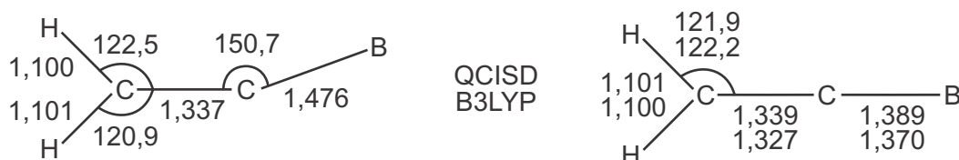
Figure 17: Structures calculées des espèces B-vinylidène ^2A' (à gauche) et ^2A_1 (à droite). En premier sont reportés les paramètres géométriques QCISD/cc-pVDZ, puis ceux B3LYP/cc-pVDZ. Les distances sont en Angström, les angles en degré. Se reporter au texte pour de plus amples détails.
