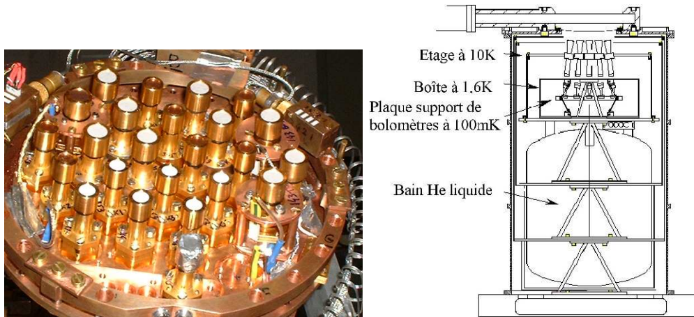
FIG. 5.5 – Gauche : Photo du plan focal complet d'Archeops. Droite : Schéma du cryostat d'Archeops et des cornets en vue de la fenêtre.
