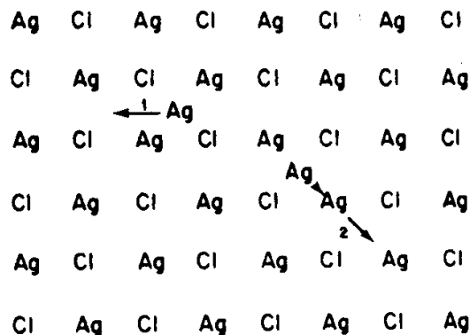
Figure 19 : Représentation schématique du déplacement des ions Ag^+ via un mécanisme interstitiel direct (1) ou indirect (2)
