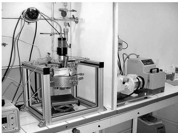
Figure 15 : Photo du banc de polymérisation
