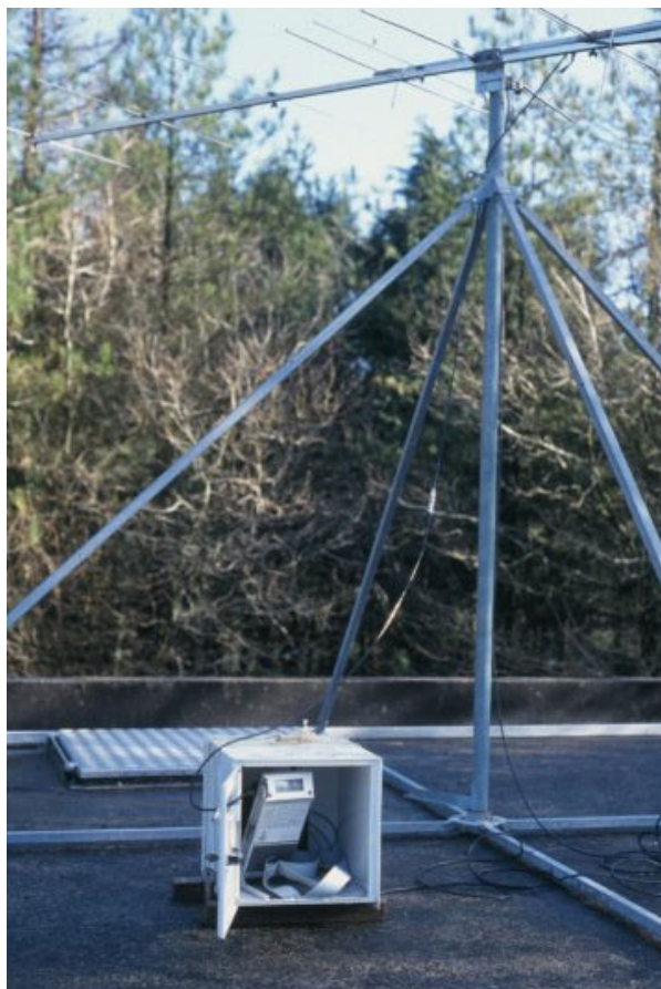
Fig. VIII.4.3 : Récepteur d'activité branché à la grande antenne de 9 brins, située au point culminant de la forêt.
