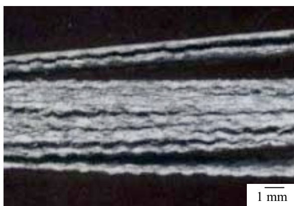
Figure IV.20 : Matériau composite K139/520, exposé 1 mois à un brouillard salin. Délaminage du matériau, dû à la dissolution de l'aluminium des zones non renforcées.
