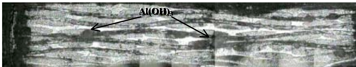
Figure III.8 : Localisation des dômes d'hydroxyde d'aluminium Al(OH)_3 . Image issue du vidéomicroscope, après 61 heures d'immersion.
