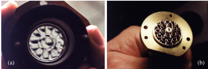
Figure 1.22 - : (a) le réseau de lentilles, (b) les têtes de fibres avec leur monture x-y-z. Un réglage que l'on ne veut pas avoir à effectuer trop souvent.
