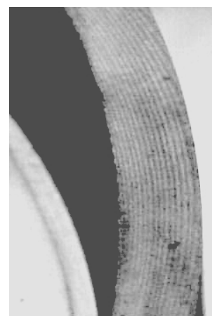
FIG. 5.4 – Exemple de franges d'interférences sur la surface du rotor
