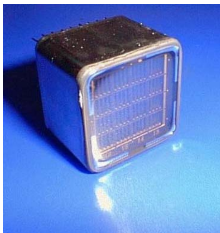
FIG. 2.12 – Photographie du photomultiplicateur de type M16 utilisé dans le RICH d'AMS-02.
