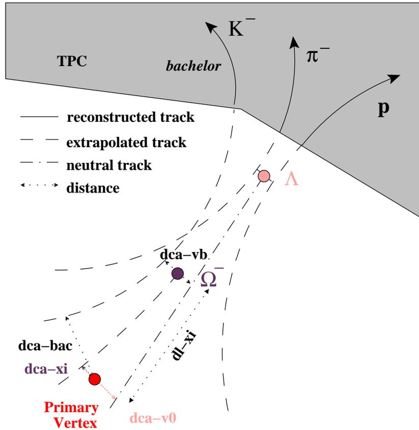
FIG. 3.6: *Reconstruction des vertex de type "Xi": cas du  $\Omega$ .*
