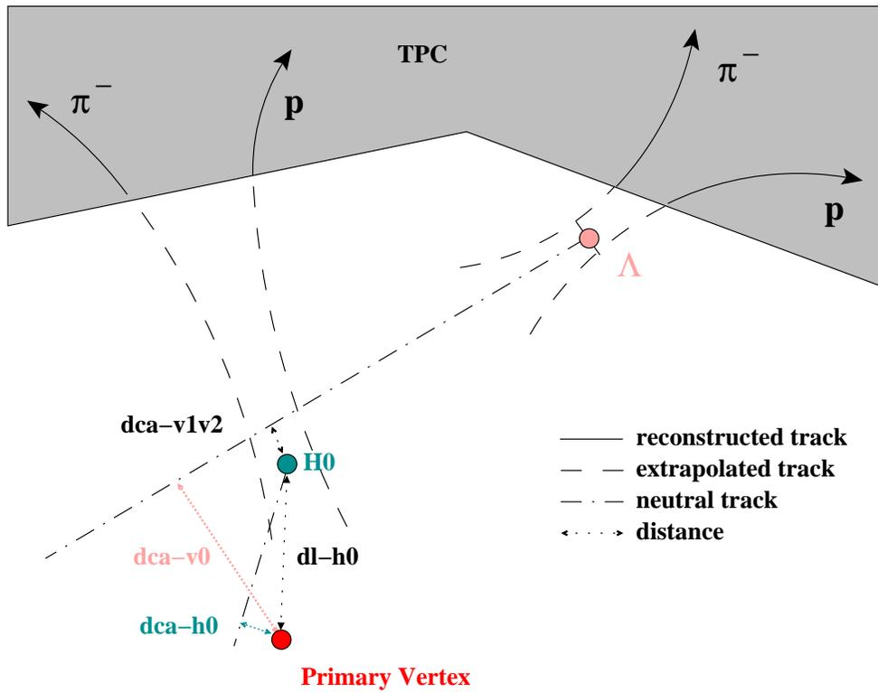
FIG. 3.8: Reconstruction des vertex de type "H0".
