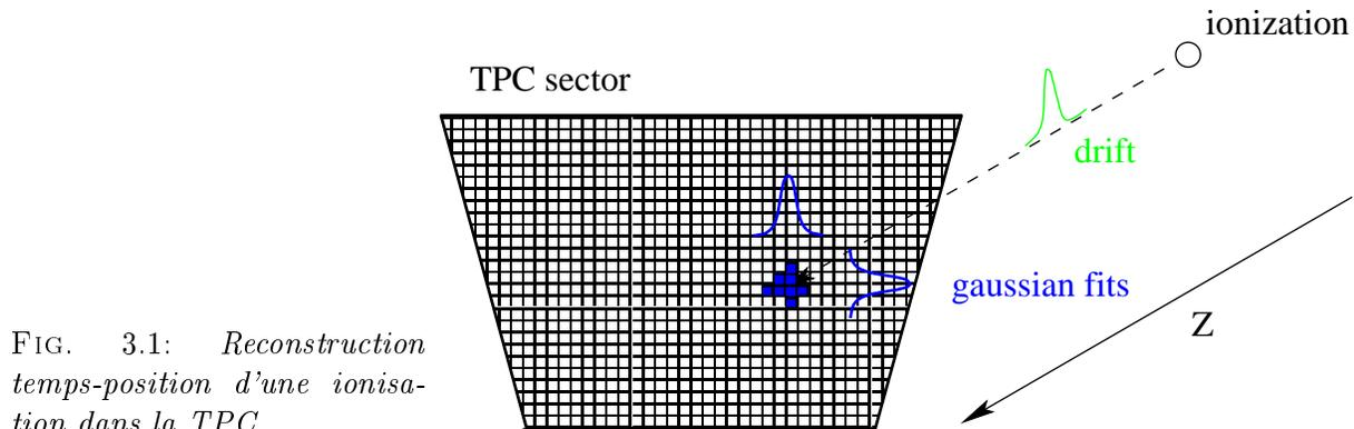
FIG. 3.1: *Reconstruction temps-position d'une ionisation dans la TPC.*
