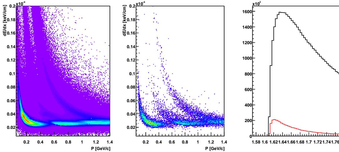
FIG. 5.6: Perte linéique d'énergie des produits de décroissance des  $\Omega$ . La distribution de gauche et celle en masse invariante à droite et en noir correspondent à une sélection en  $dE/dx$  de  $5\sigma$ . La distribution centrale est celle des produits de décroissance une fois la sélection à  $3\sigma$  appliquée. La distribution en masse invariante des candidats  $\Omega$  sélectionnés est représentée en rouge.
