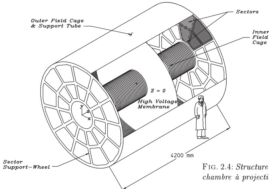
FIG. 2.4: Structure et volume de la chambre à projection temporelle.
