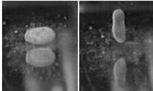
Figure 5 : Rebond d'une goutte d'eau lycopodée de 50 \mu L, sur un surface réfléchissante.
