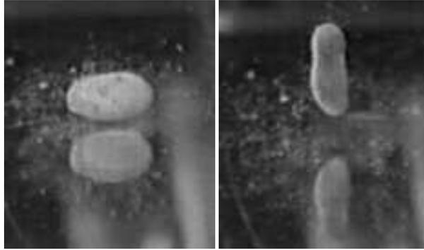
Figure 5 : Rebond d'une goutte d'eau lycopodée de 50 $\mu$ L, sur un surface réfléchissante.
