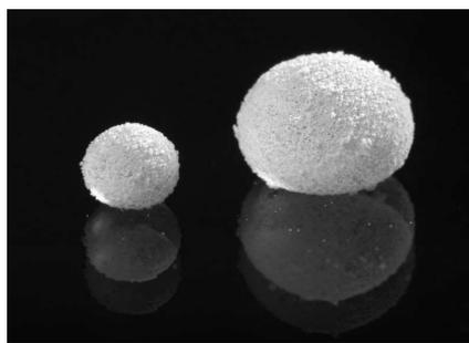
Figure 12 : Formes expérimentales de gouttes enrobées, en dessous de la longueur capillaire (petite goutte sphérique) et pour une taille de l'ordre de la longueur capillaire (grosse goutte légèrement aplatie).
