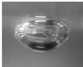
Figure 1 : Bulle sous un solide qu'elle ne « mouille » pas.
