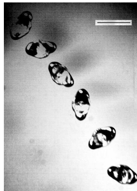
Figure 10 : Chute libre d'une goutte d'étain après un plan incliné à 30°. Il y a 10 ms entre chaque image.
