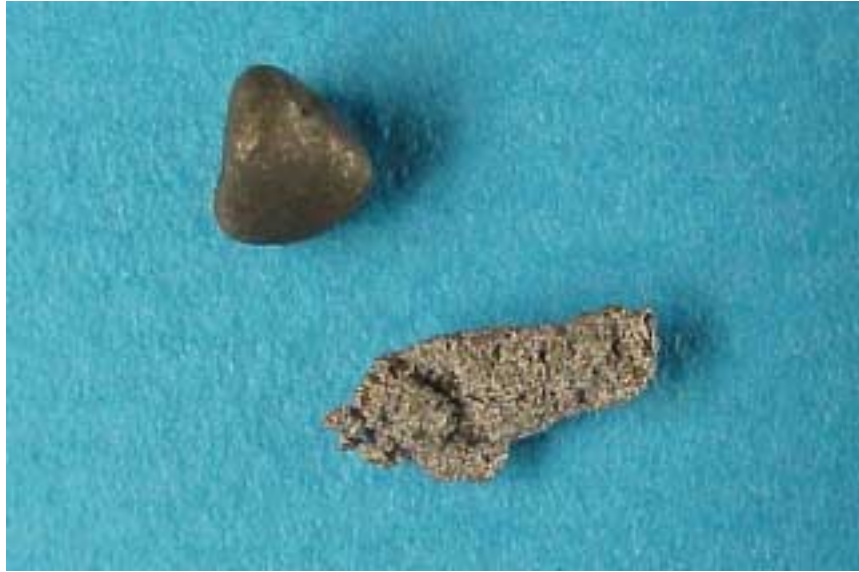
FIG. 3.20 - Photographie d'éponges de titane broyée (gauche) et non broyée (droite)
