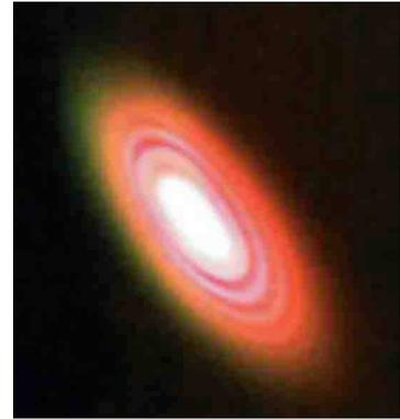
FIGURE 5.8 – Photographie du cône spectral du continuum.
