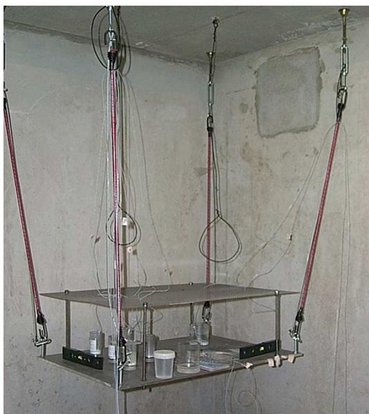
FIGURE 2.12 – La table de sédimentation constituée d'un système de tendeurs qui permet d'isoler la table des vibrations.
