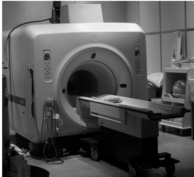
Figure III.2 : Imageur 1,5T installé au CIERM à l'hôpital du Kremlin-Bicêtre.
