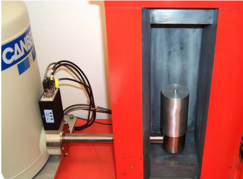
Figure 24 : Photo du spectromètre Ge(HP) dans son blindage de plomb bas bruit de fond
