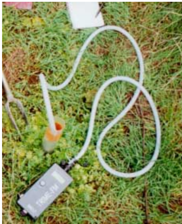
Figure III-31 : Photographie de la sonde TDR Trime de IMKO, avec la tarière pour la comparaison des mesures, sur la parcelle enherbée, site de Rouffach (68, France).
