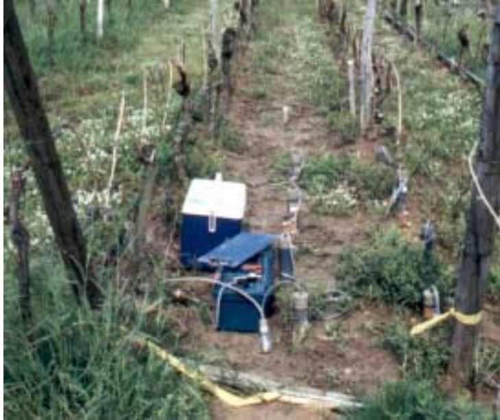
Figure III-32 : Equipement pratique (pompe à vide électrique, flacon, glacière) pour le prélèvement de la solution du sol, sur la station 4 de la parcelle désherbée, site de Rouffach (68, France).
