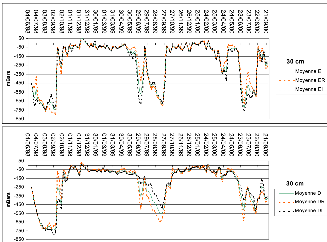
Figure IV-12 : Comparaison des potentiels matriciels pour mettre en évidence les effets de rang en parcelle enherbée (E, ER et EI, figure du haut) et en parcelle désherbée (D, DR et DI, figure du bas) à 30 cm de profondeur, site de Rouffach (68, France).
