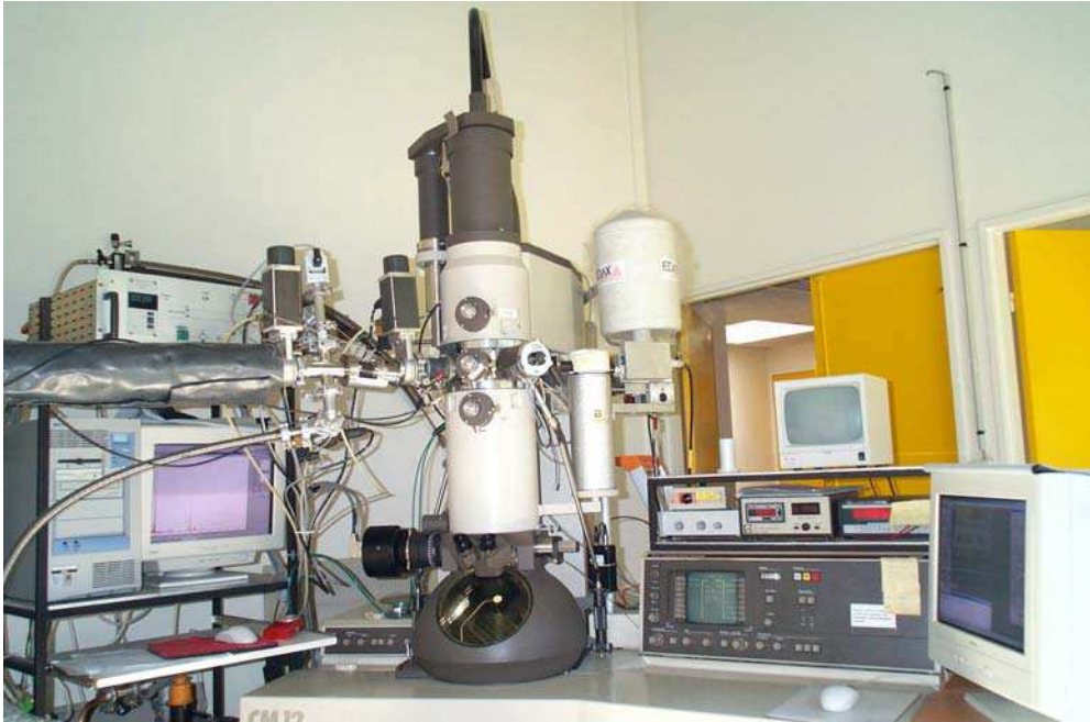
Figure 17 : Microscope électronique à transmission Philips CM12 120 keV couplé à l'implanteur d'ions basse énergie IRMA
