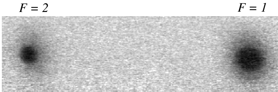
FIG. 3.3 – B_0 = 56\text{ G} : images de deux condensats dans les états |F = 1, m_F = -1\rangle et |F = 2, m_F = +2\rangle obtenus par refroidissement sympathique. Un gradient appliqué brièvement durant la coupure du piège permet de séparer par effet Stern et Gerlach les deux condensats.
