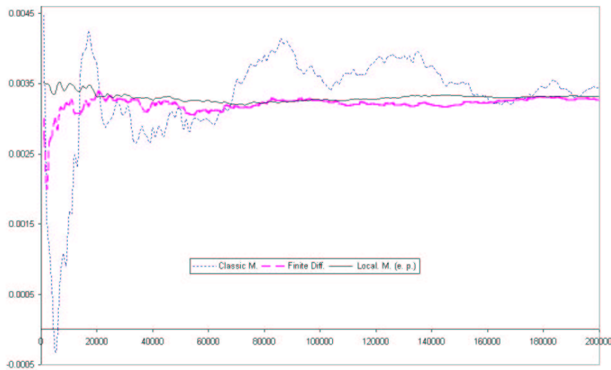
FIG. 3.1 – Évolution de 3 estimateurs Monte-Carlo en fonction du nombre de trajectoires M : pour M = 200000 , les intervalles de confiance à 95% ont pour largeur 7.08 \times 10^{-4} (différences finies), 1.82 \times 10^{-3} (estimateur de [FLL + 99]) et 1.7 \times 10^{-4} (notre estimateur).
