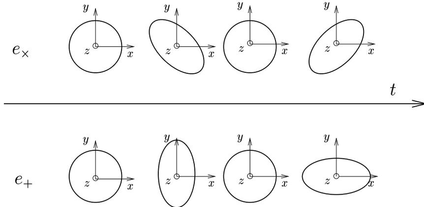
FIG. 1.2 – Déformation d'une distribution de masses libres réparties sur un anneau sous les effets des polarisations  $\{h_+, h_\times\}$  d'une onde gravitationnelle (ces effets sont déphasés de  $\pi/2$  dans le cas d'un signal provenant d'un pulsar, voir les formules 4.6 et 4.7).
