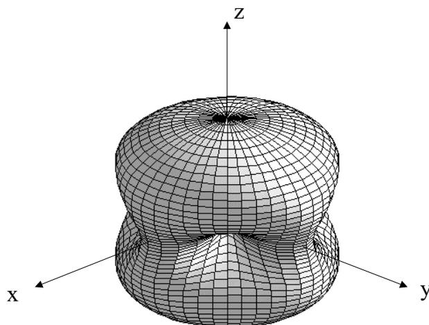
FIG. 2.2 – Sensibilité d'un interféromètre en fonction de la direction d'incidence d'une onde gravitationnelle non polarisée (les bras de l'interféromètre sont confondus avec les axes  $(Ox)$  et  $(Oy)$ ) [37].
