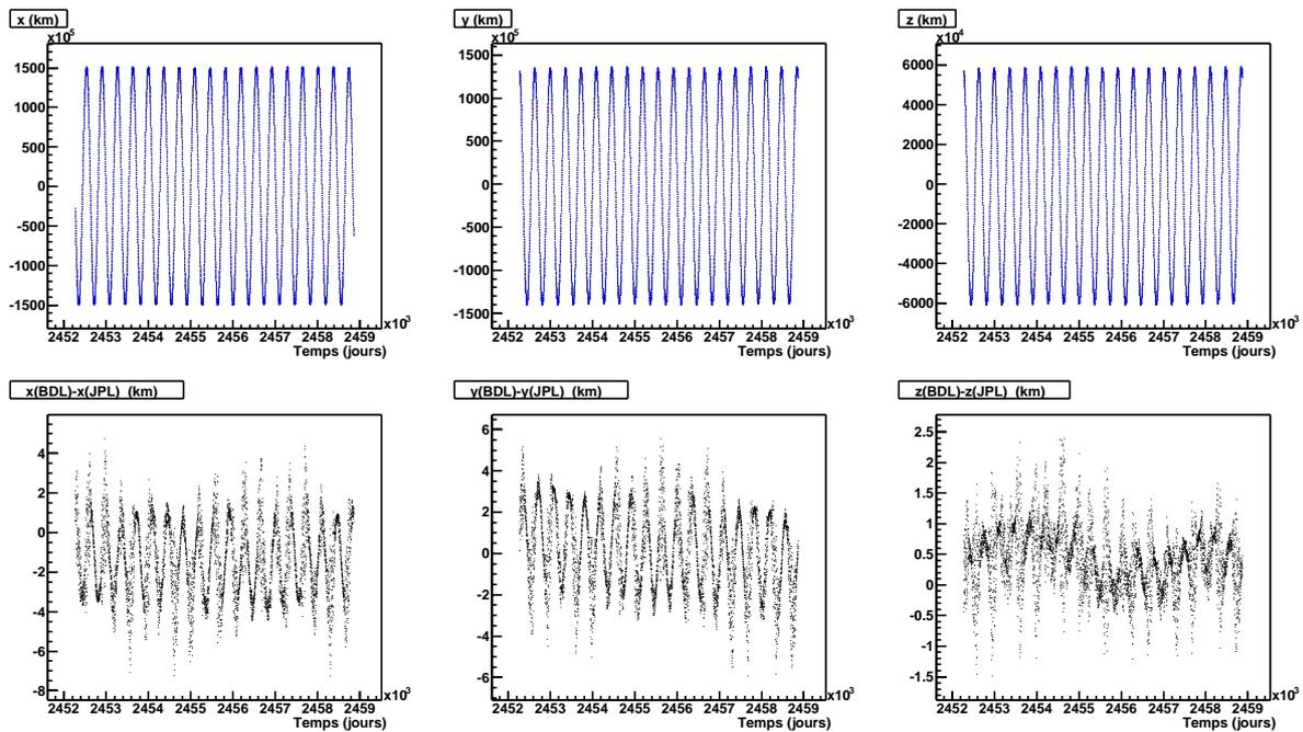
FIG. 5.6 – Superposition des composantes  $(x,y,z)$  de la position de la Terre par rapport au barycentre du Système Solaire en sortie des algorithmes du BDL et du JPL, pendant la période 2002-2020, et différences.
