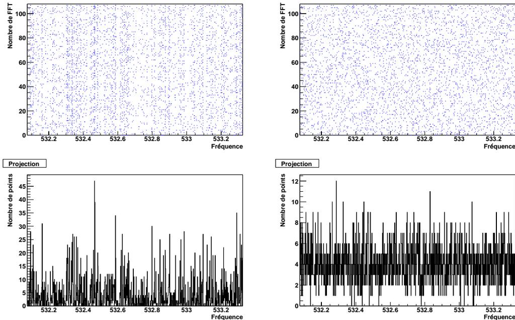
FIG. 5.12 – Diagrammes temps-fréquence générés avec l’ancien et le nouveau générateur de nombres aléatoires utilisés dans SIESTA, l’un comportant des raies, l’autre pas, et leur projection sur l’axe des fréquences.
