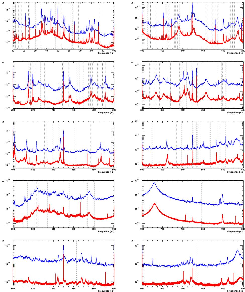
FIG. 7.8 – Spectre des données du run E4, pour le bruit seul intégré pendant 1 seconde (courbe bleue), et pour le bruit et le signal simulé intégré pendant 800 secondes (courbe rouge) et pulsars inclus dans la simulation (les lignes brisées représentent les fréquences des pulsars, les lignes en pointillé les fréquences doubles).
