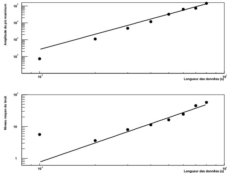
FIG. 7.4 – Variation de la hauteur du pic maximum (et son ajustement par la fonction  $C_n^3$ ) et la variation de la valeur moyenne du bruit (et son ajustement par  $n^2$ ) en fonction de la longueur des données disponibles.
