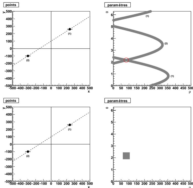
FIG. B.5 – Transformées de Hough "élargies" à 1 et 2 points.
