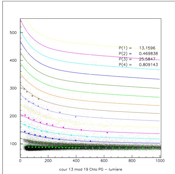
FIG. 2.7 – Corrélation signal petit gain dans la ChIo-quantité de lumière dans le scintillateur; les maxima de lignes de crête relevés (les points) sont ajustés avec la fonctionnelle  $F$  donnée par 2.10 (les courbes).
