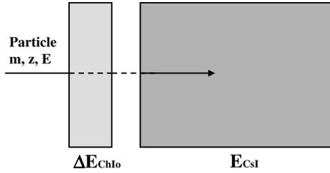
FIG. 2.1 – Principe de la méthode  $\Delta E - E$  (interaction de la particule avec la matière.)
