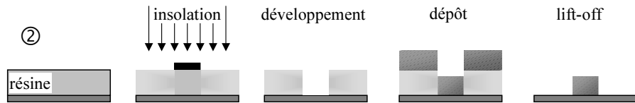
FIG. 3.2 – Schéma de la technique de lift-off avec utilisation d'une résine négative
