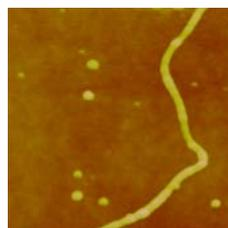
**Figure II.26 :** Image en mode tapping après une mesure de courant ponctuelle. La corde d'ADN est déposée sur une surface méthyle. On voit l'électrode en or. Le brin a été coupé et s'est replié sur la zone indiquée par une flèche. La taille de l'image est de  $3\mu\text{m} \times 3\mu\text{m}$ .
