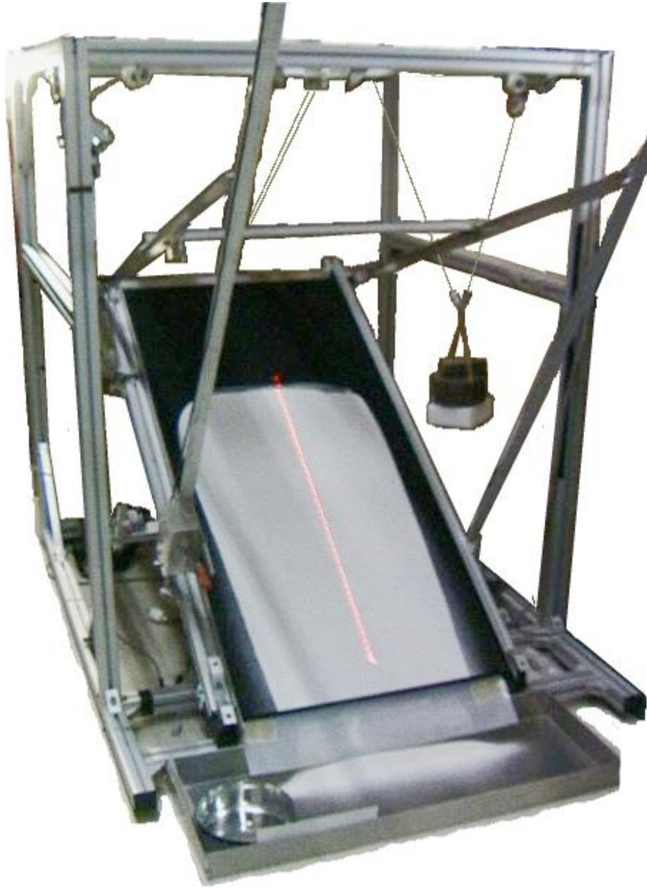
FIG. 2.1. – Photographie de l'expérience. La structure cubique en profilé supporte le système de traction (poulies en haut, moteur en haut à gauche, contrepoids à droite) et le plan sur deux charnières en bas. La caméra (en dehors de l'image) est fixée sur une structure solidaire au plan. Les billes de verre recouvrent une partie du plan (partie blanche) et forment un tas dans le bac collecteur. La ligne claire sur la couche provient d'une diode LASER montée sur le cadre du plan.
