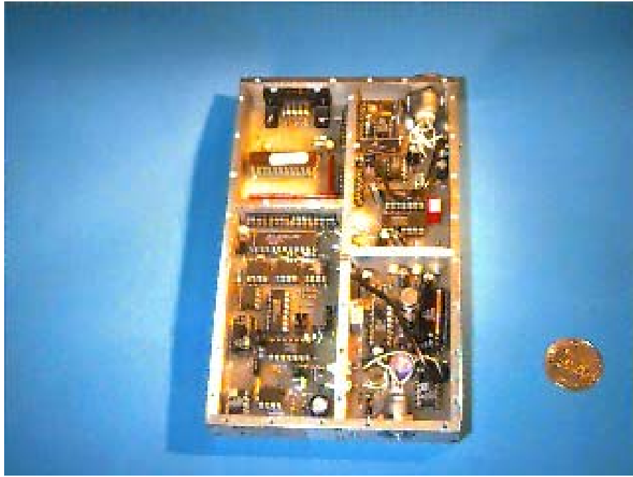
Figure 4.18: Photographie du boîtier MLPA à côté d'une pièce de 1 franc. L'implémentation globale est identique au schéma de la figure 4.17. On remarquera le blindage important entre chaque fonction.
