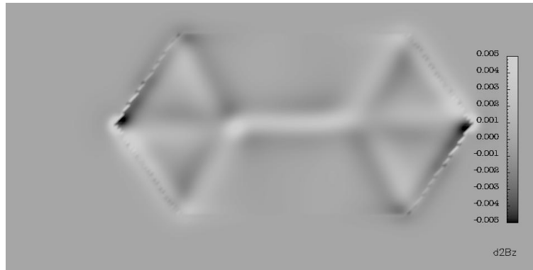
FIG. 5.13 – Carte de d^2Hz/dz^2 calculée à partir de la configuration micromagnétique de la Figure 5.12 avec une hauteur de vol au dessus de l'îlot de 30nm à comparer avec l'image MFM de la Figure 5.6b.
