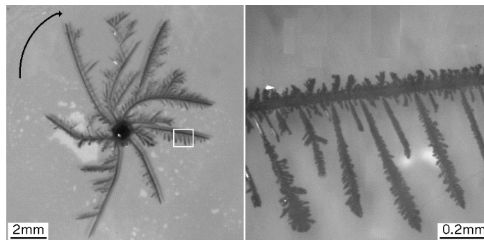
Fig. III.28 Croissance dissymétrique obtenue dans les conditions; 0.3M, 10V, 1.2T, 50 \mu\text{m} . On voit que les branches qui poussent dans le sens du mouvement global de la solution sont plus longues que celles qui poussent dans le sens contraire.
