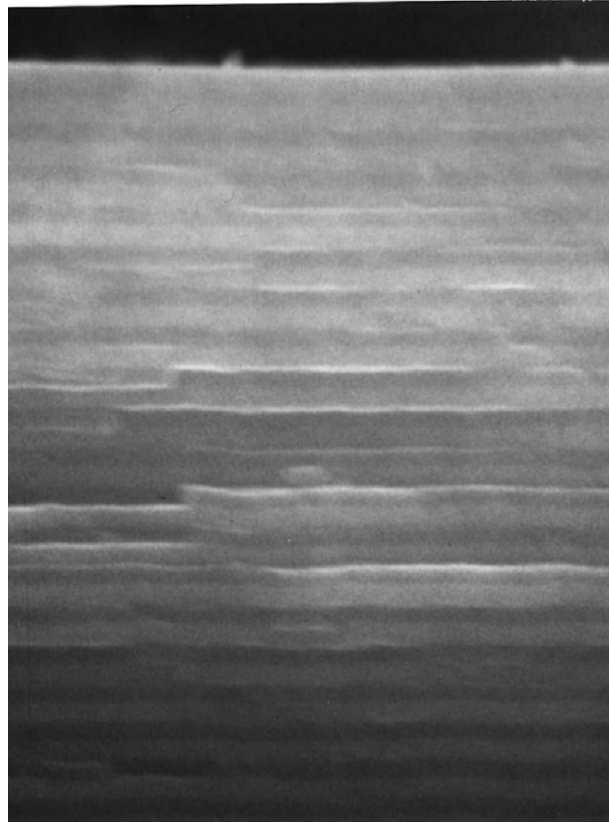
Figure 63 : Photographie prise avec un microscope électronique à balayage d'un miroir de Bragg centré à 800 nm. La modulation de porosité est visible.
