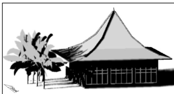
**Figure 3-55 :** Vérification de l'ensoleillement des fenêtres ouest de la maison *Joglo* pour la journée du 21 décembre à 17 h. Simulation réalisée par lancer de rayon, avec le logiciel mère *AutoCAD*. Les fenêtres ouest sont totalement à l'ombre.
