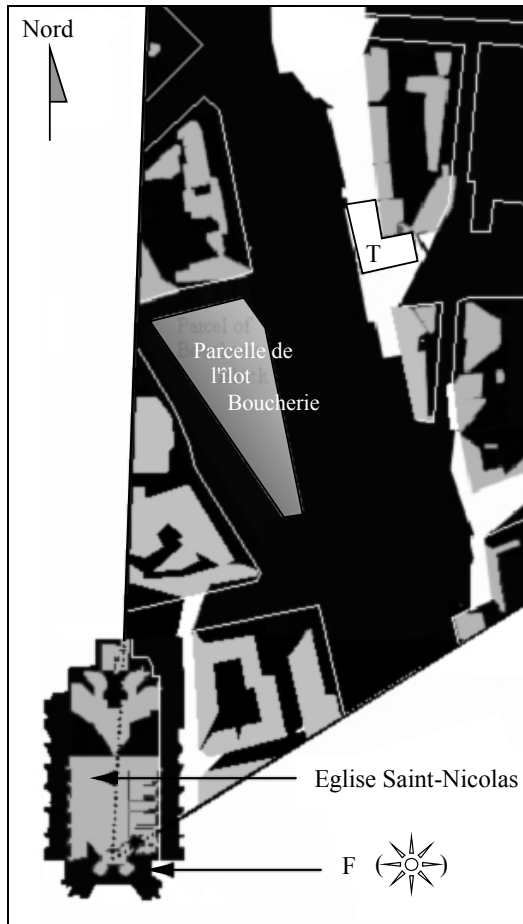
Figure 3-114 : Simulation de l'accessibilité visuelle pour le projet de l'îlot Boucherie à Nantes. La fonctionnalité source lumineuse du logiciel mère est détournée pour analyser quelles zones de la ville sont "à l'ombre" (ne voyant pas la source) ou "à la lumière" (voyant la source). La contrainte visuelle imaginée pour le test a donc pour cible la flèche F de l'église Saint-Nicolas ("source lumineuse") et pour base une surface "à la lumière". Ici la surface choisie est la translattée (T') de la terrasse T à hauteur des yeux en position assise.
