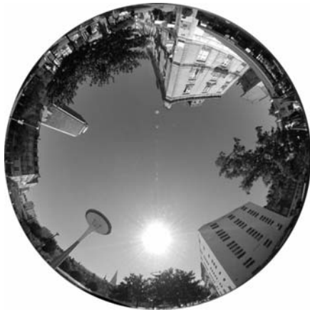
Figure 2-24 : Masques environnants 2D d'un point à la hauteur du sol. Image fish-eye depuis le parvis de l'hôtel La Pérouse à Nantes (France). Parmi les masques, sont repérables, les deux flèches de l'Eglise St-Nicolas à droite du lampadaire et la Tour de Bretagne, à gauche.
