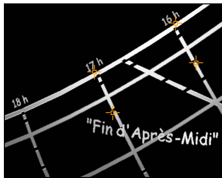
Figure 2-22 : Zoom sur les intersections entre les trajectoires solaires apparentes et les heures solaires. Les périodes solaires du type "fin d'après-midi" sont dites "élastiques" ; elles divisent en six les journées d'ensoleillement plus ou moins longues entre le 21 décembre et le 21 juin. Pour cet exemple, le concepteur choisit la période solaire 16 h - 17 h du 10 mai au 1 er août, il doit saisir les points extérieurs des doubles trajectoires (les 4 curseurs), afin de prendre en compte l'épaisseur apparente du soleil.
