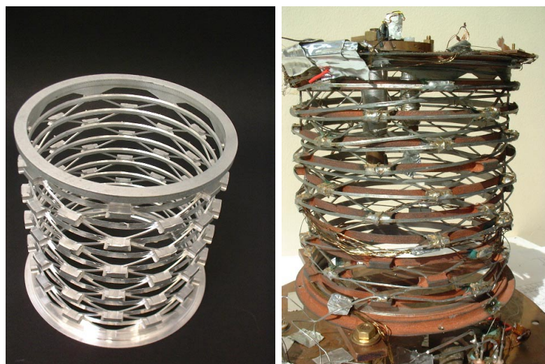
FIG. 3.7 – Photographie de l'échangeur. A gauche le support en Inox sans l'échangeur et à droite l'échangeur monté sur le support choupé cuivre.
