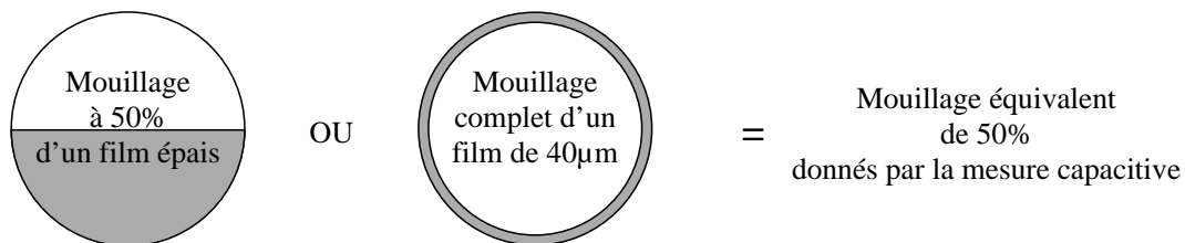
FIG. 4.24: Dans le cas où un seul condensateur serait plaqué sur la totalité du périmètre, la sonde capacitive ne distinguerait pas un mouillage par le liquide de 50% du périmètre par un film épais d'un mouillage total du périmètre par un film de 40 \mu\text{m} .
