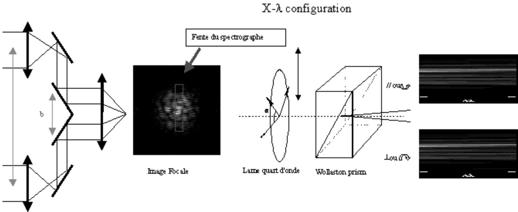
Figure 40. Schéma illustratif du chemin lumineux dans le cas d'un Interféromètre muni d'un spectropolarimètre. Les étapes sont la recombinaison des faisceaux, puis l'analyse de la polarisation et enfin la dispersion. Le prisme de Wollaston a deux positions de travail, à  $0^\circ$  et  $180^\circ$ , la lame quart d'onde est escamotable
