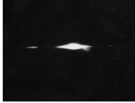
FIG. 4.12: Photographie du mode fondamental en sortie de guide pour l'hétérostructure de type Al_{0.03}Ga_{0.97}As/GaAs/Al_{0.03}Ga_{0.97}As avec \lambda_0 = 1.3 \mu m .
