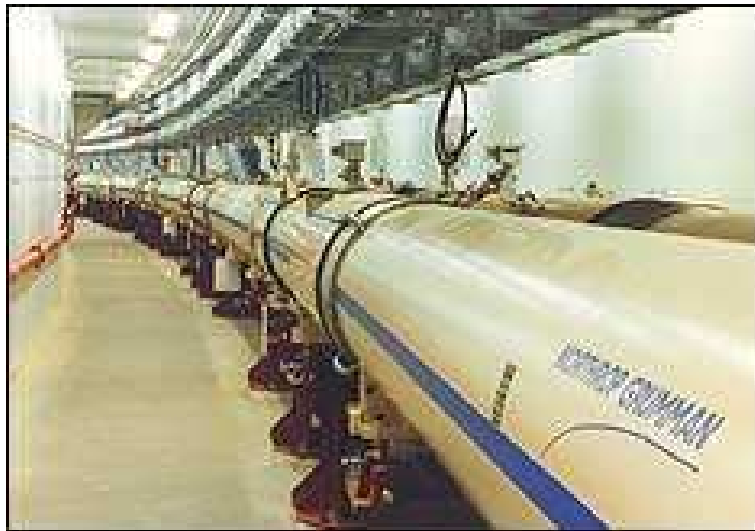
FIG. 7.3 – Accélérateur d'ions lourds RHIC, en service depuis juin 2000 au Brookhaven National Laboratory, Long Island, New York [source : http://www.bnl.gov/rhic/ ].
