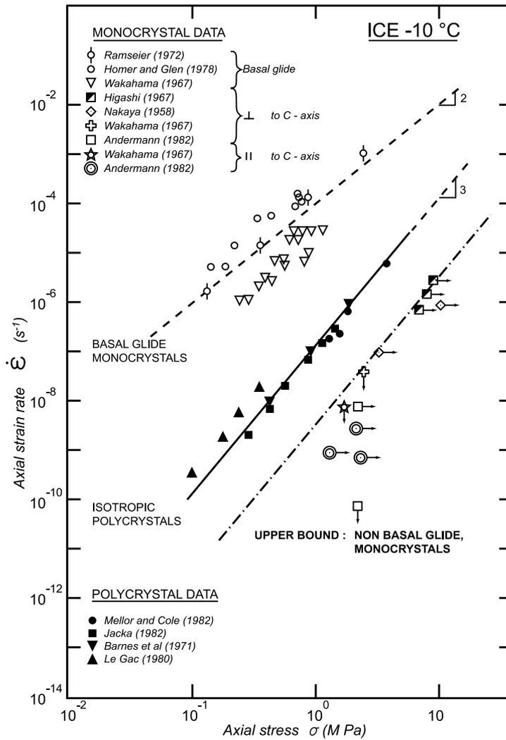
**Fig. 1.2 :** Relation entre la vitesse de déformation équivalente et la contrainte équivalente pour la glace isotrope et le monocristal déformé par glissement basal et non basal, d'après Duval et al. (1983).
