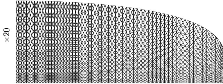
**Fig. 6.2** : Exemple de maillage lorsque  $N_{b1} = 60$ ,  $N_{b2} = 15$ ,  $r_1 = 1.1$  et  $r_2 = 1.1$ . L'échelle selon la verticale est 20 fois supérieure à celle selon l'horizontale. On peut observer la progression de la taille des éléments selon l'horizontale et la verticale.
