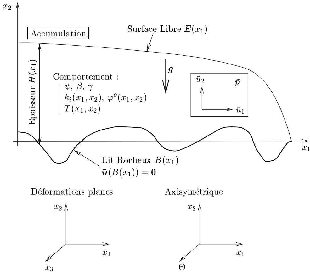
**Fig. 6.1** : Schématisation du problème à résoudre. Pour une section verticale donnée, l'écoulement est soit en déformations planes soit axisymétrique. Les quantités encadrées sont des résultats du calcul et les autres des données d'entrée du calcul.
