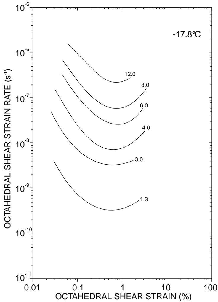
**Fig. 1.3** : Courbes de fluage de la glace polycristalline isotrope en compression uniaxiale pour différentes valeurs de la contrainte (en bar), d'après Jacka (1984).
