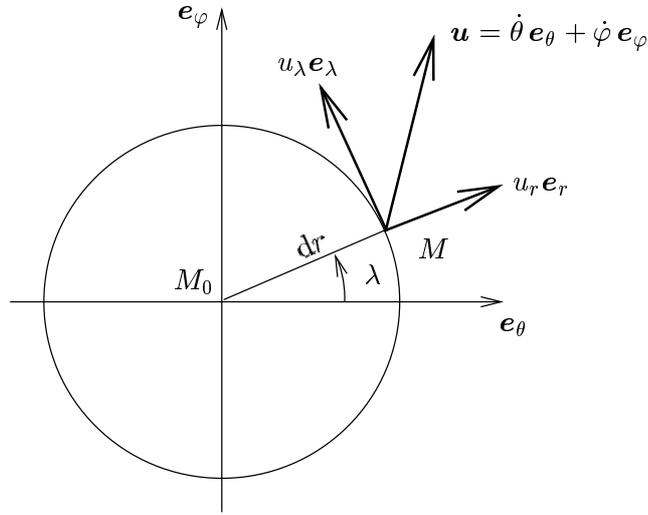
**Fig. B.1** : Définition des notations utilisées pour l'étude de la stabilité de l'équilibre au point  $M_0(\theta_0, \varphi_0)$ .
