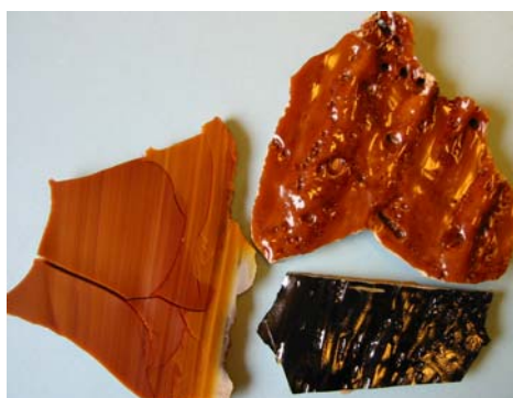
Figure 2.11 : Résidus solides qui se forment sur la paroi du réacteur du finisseur
