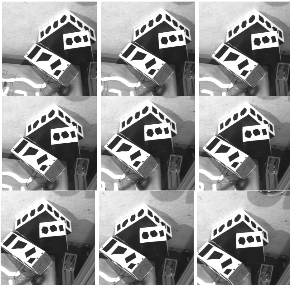
FIG. 2.4: La séquence de 9 images utilisées pour l'auto-étalonnage
