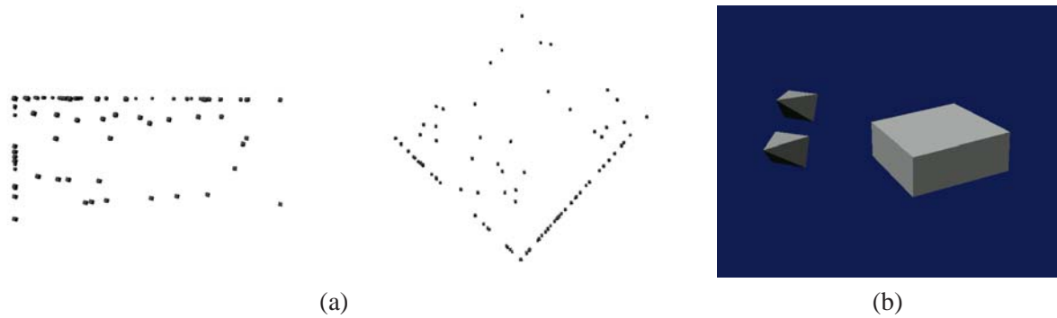
FIG. A.9 – Modèle obtenu pour le modem, (a) montre la reconstruction éparsée contrainte par les plans et (b) montre le modèle 3D consistant de 3 plans délimités et des deux caméras. On observe en (a) que les points reconstruits sont parfaitement coplanaires.
