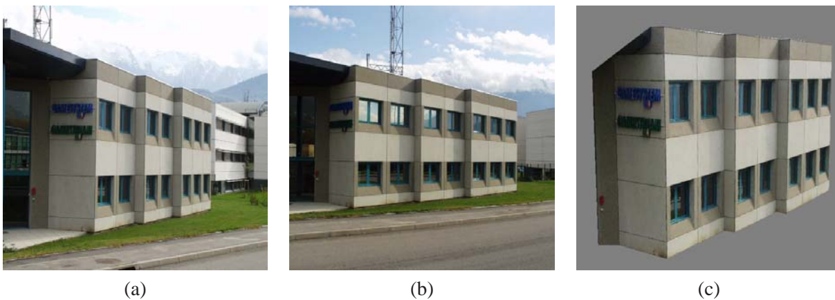
FIG. 5.1 – (a) et (b) : paire d'images d'une scène plane par morceaux, appelée "game system I" et (c) : modèle métrique reconstruit, consistant de 109 points et de 7 plans. Le rendu texturé est obtenu par correction perspective des textures des images originales vers l'image synthétique.
