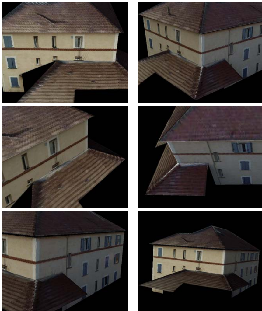
FIG. 5.19 – Différentes vues du modèle métrique texturé. On note quelques artefacts introduits par des parties non planes non modélisées de la scène, par exemple le poteau sur le toit dans l'image en haut à droite est intégré au plan du toit et apparaît distordu dans les autres images, par exemple en haut à gauche.
