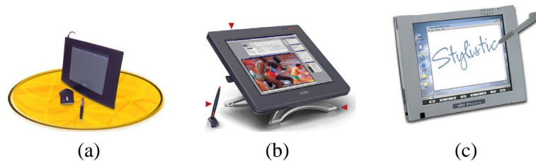
FIG. 1.88: Exemples de tablettes. (a) tablette Intuos2 de Wacom (b) tablette combinée à un écran LCD Cintiq de Wacom et (c) un tablet PC le modèle Stylistic 3500 de Fujitsu
