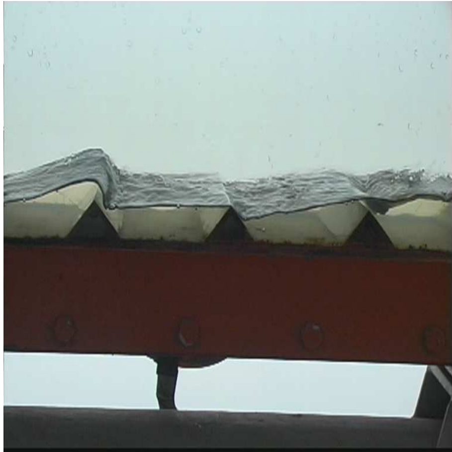
FIG. 1 – Instabilité des ondes de surfaces sur un fond périodique. Travail en cours de D. Astruc, N. Dolez, O. Thual, Equipe Onde et Turbulence IMFT. Photo : A.L. Le Fessant, thèse 2001 de l'IMFT.
