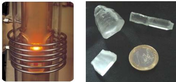
Figure 1-20 – Méthode de Czochralski. À gauche, vue intérieure d'un système commercial de croissance cristalline. À droite, exemple d'échantillons d'Yb: SYS.
