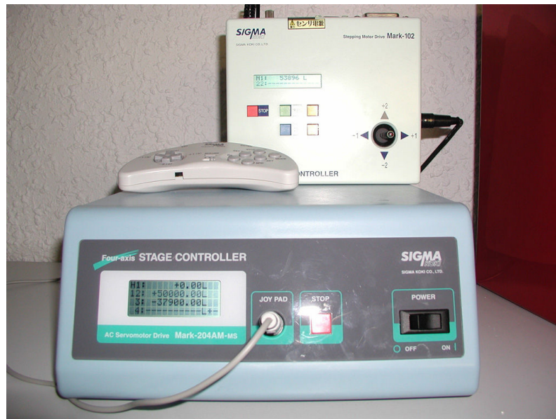
Fig. 2.11 : Contrôleur de la table : Interface PC/Table
