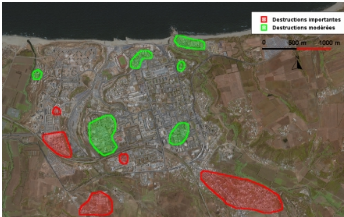
Figure 4.44 Cartographie de zones affectées sur l'ensemble de la ville de Boumerdes, suite au séisme du 21 mai 2003 (source de l' image de fond : DigitalGlobe).
