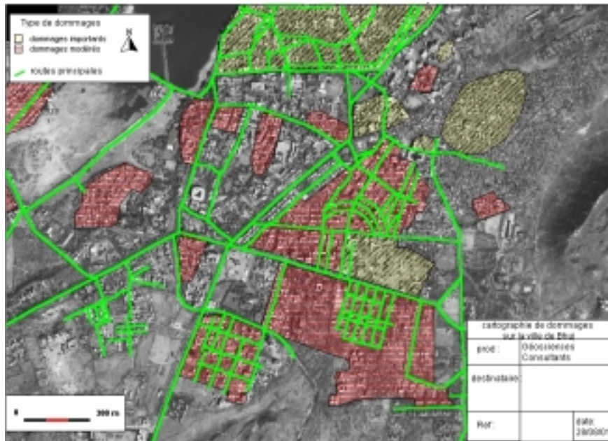
Figure 4.3 Cartographies de dommages sur la ville de Bhuj à l'aide des simulations multi - temporelles SPOT 5 (source : André et al, 2001).
