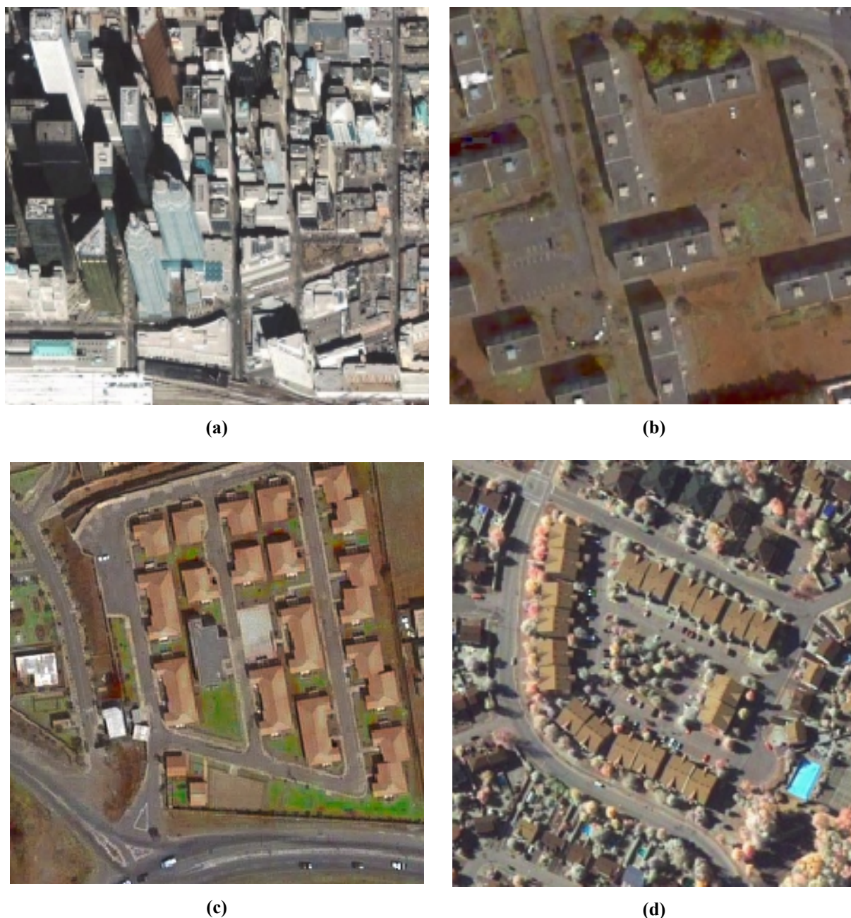
Figure 4.45 Exemple des différents types de bâti, reconnaissables à l'aide de l'imagerie satellitaire. Centre urbain moderne, formé par des bâtiments hauts, de plus de 10 niveaux (a) ; bâtiments à habitats collectifs, d'environ 5 étages (b) ; exemple des secteurs pavillonnaires (c) et (d). (source images : Space Imaging et DigitalGlobe).
