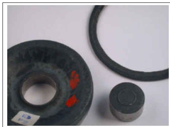
Figure 4.24 : Roue ébavurée et débouchée, essai expérimental (source CETIM©)
