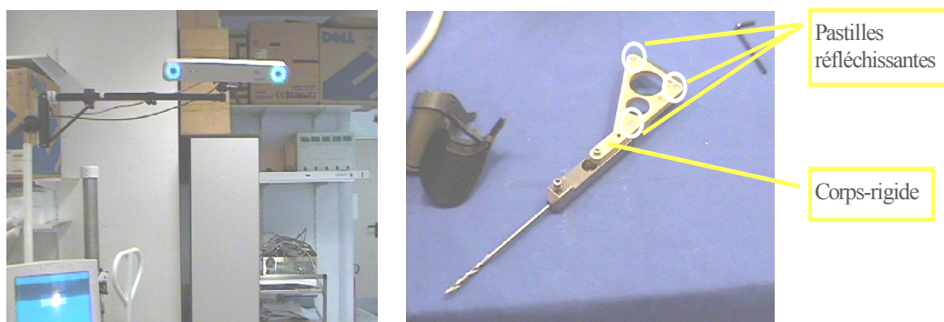
Figure 49 Matériel de localisation utilisé dans CASPER : les caméras du Polaris (à gauche), un foret muni d'un corps-rigide doté de 3 pastilles réfléchissantes (à droite).
